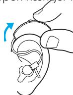
2. Hold ledningen ved knækket foran receiveren med din tommel- og pegefingre. Indsæt forsigtigt receiveren i øregangen.
