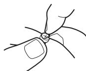
4. Placer batteriets "+" tegn (den flade side af batteriet) væk fra batteridøren.
